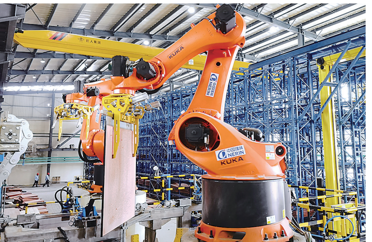
图为凉山铜业智能剥片机组进行阴极铜剥壳作业。 陈小英 摄
