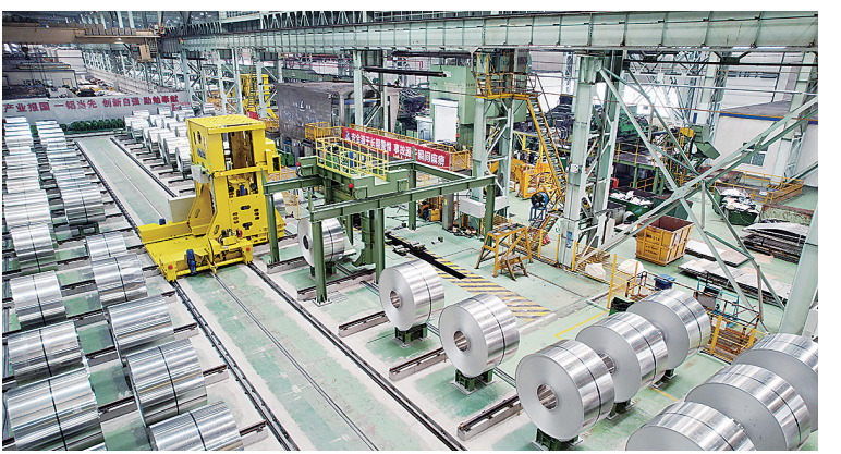
▲图为国内首套高温热轧卷材智能仓储物流系统应用现场。杨舵 摄
