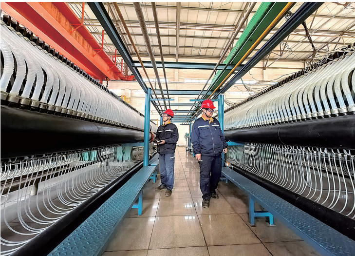
▲图为山东铝业员工巡检氯碱电解槽。 万红义 摄
