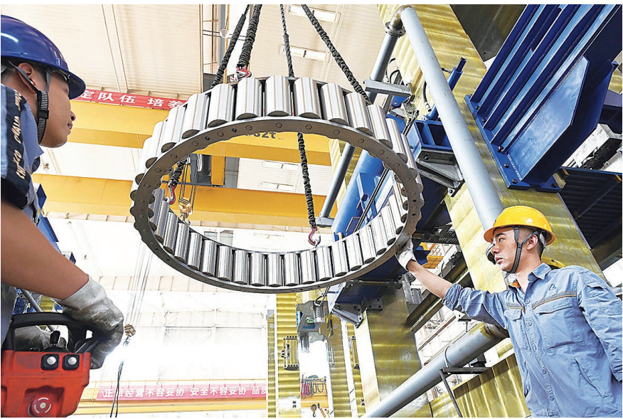
▲图为中色科技员工进行大型轴承部件装配作业。
