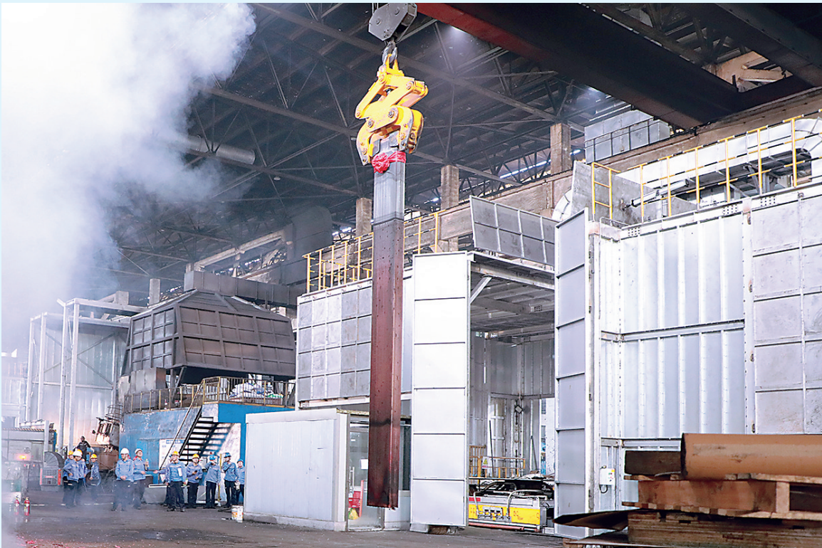
▲图为双10吨高性能铜合金熔铸机组浇铸出的首根铸锭起吊现场。
