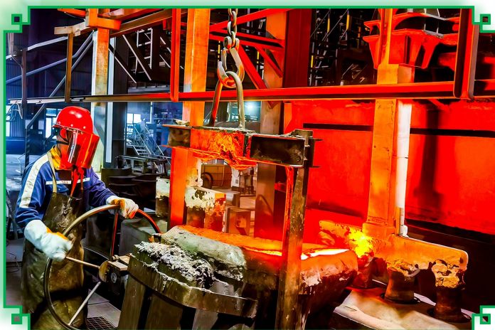
图为遵义铝业员工进行阴极浇铸作业。 梁艳旺 摄
