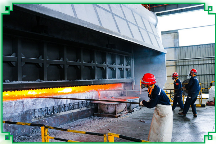
图为云铝润鑫扒渣作业现场。 赵艳芬 摄
