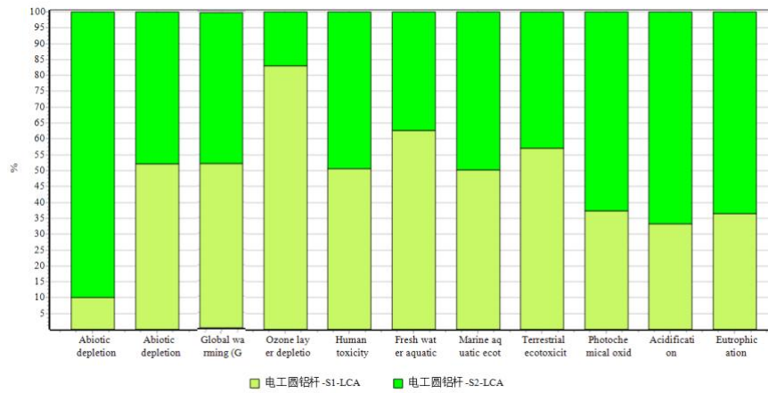
图 4 电工圆铝杆产品生命周期阶段分析
