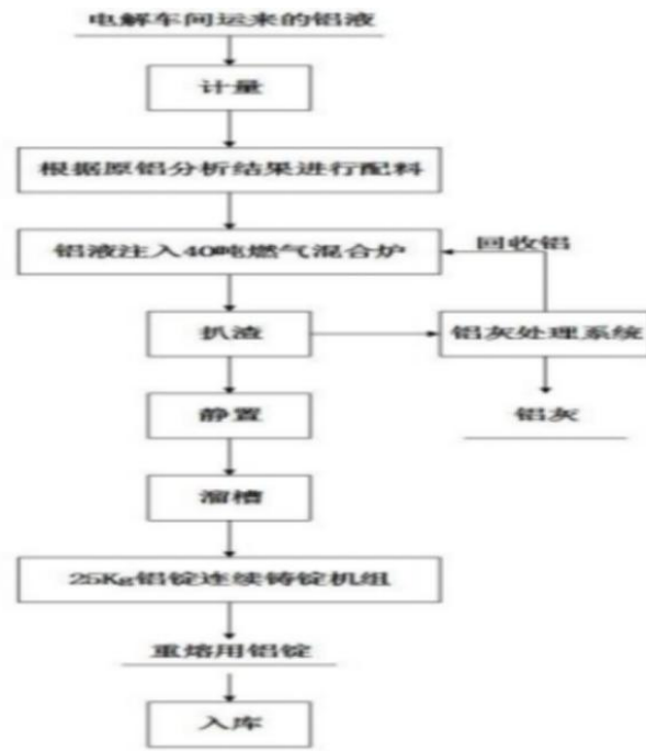
图 5 重熔用铝锭生产工艺流程图
